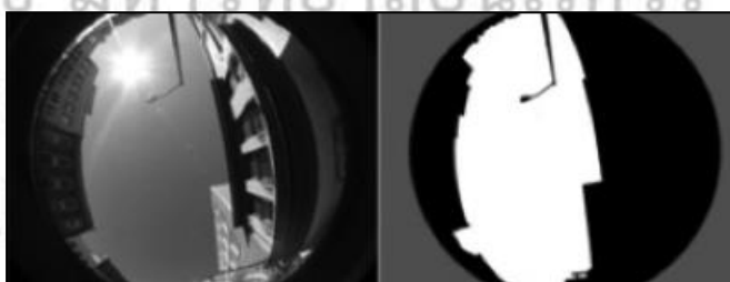
ภาพ 2.9 ภาพถ่ายภาพลักษณะเลนส์ Fish-eye (ภาพถ่าย) และภาพที่ได้จาก Photoshop Analysis (ภาพขาว) ซึ่งมีค่า SVF เท่ากับ 0.44
