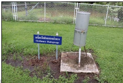
ภาพ 2.2 เครื่องวัดน้ำฝนมาตรฐานขนาด 8 นิ้ว
