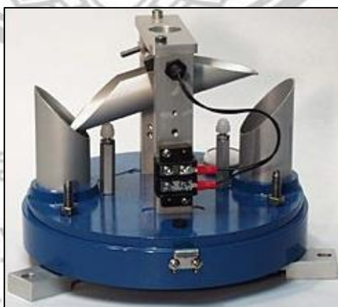
ภาพ 2.3 เครื่องวัดน้ำฝนแบบถ้วยกระดก
