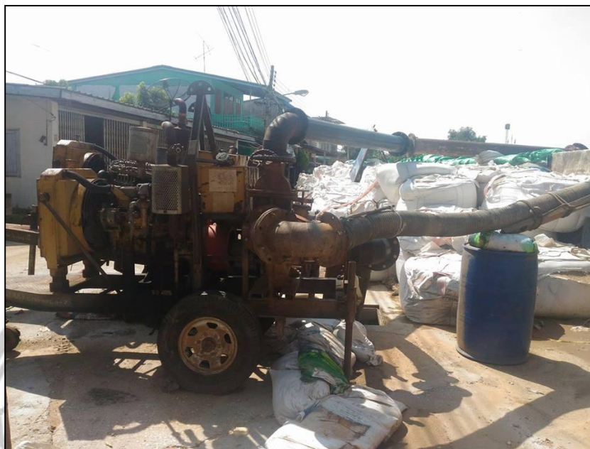
เครื่องสูบน้ำ ระบายน้ำท่วมขังในพื้นที่ลุ่มสูบน้ำยม
