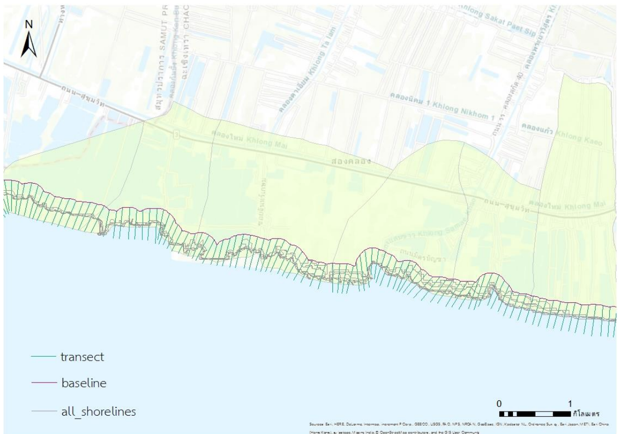
ภาพ 3.1 แผนที่แสดงข้อมูลเส้นชายฝั่ง (Shoreline) ข้อมูลเส้นฐาน (Baseline) และข้อมูลเส้นตัดขวาง (Transect) โดยใช้เครื่องมือ DSAS ในโปรแกรมระบบสารสนเทศภูมิศาสตร์
