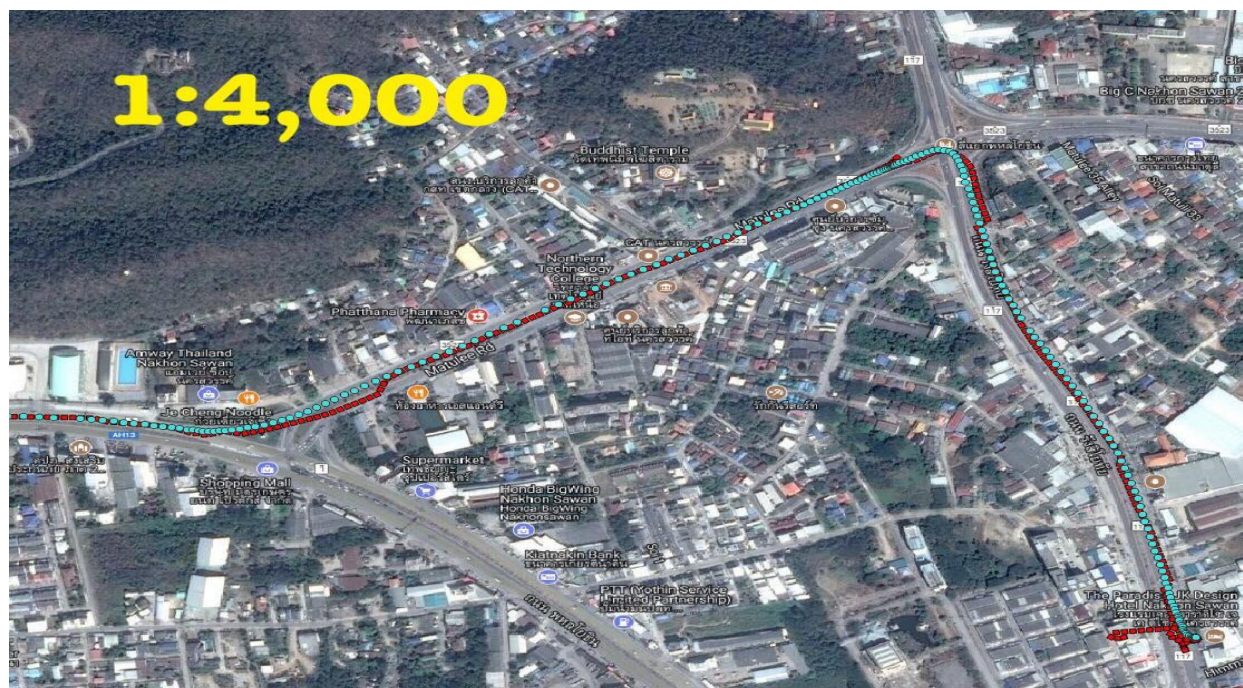
ภาพที่ 9 เที่ยบความแม่นยำของเซนเซอร์ GPS (ฟ้า) กับ GPS ในโทรศัพท์มือถือ (แดง) ในมาตราส่วน 1 : 4000
