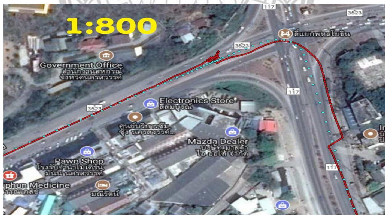
ภาพที่ 10 เที่ยบความแม่นยำของเซนเซอร์ GPS (ฟ้า) กับ GPS ในโทรศัพท์มือถือ (แดง) ในมาตราส่วน 1 : 800
