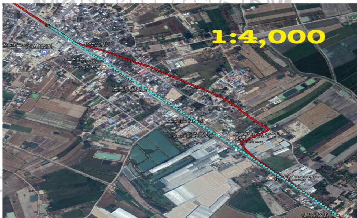
ภาพที่ 7 ผลลัพธ์การนำพิกัดจาก GPS Tracking มาแสดงเป็นชั้นข้อมูลบน QGIS
