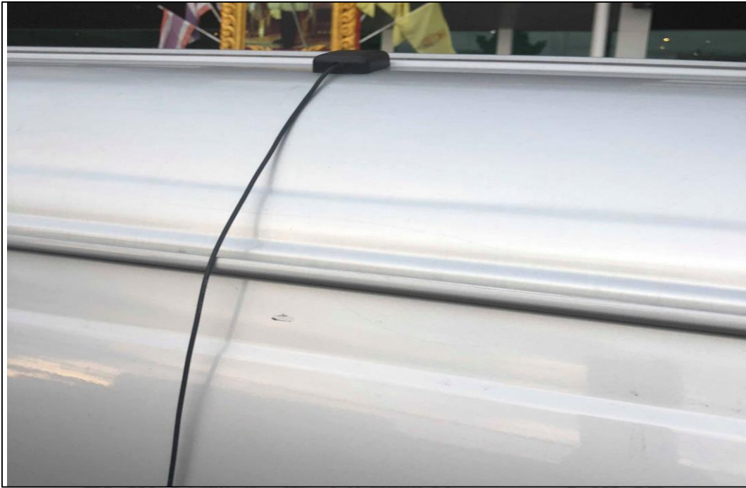
ภาพที่ 1 การติด GPS Antenna ไว้กับรถยนต์
