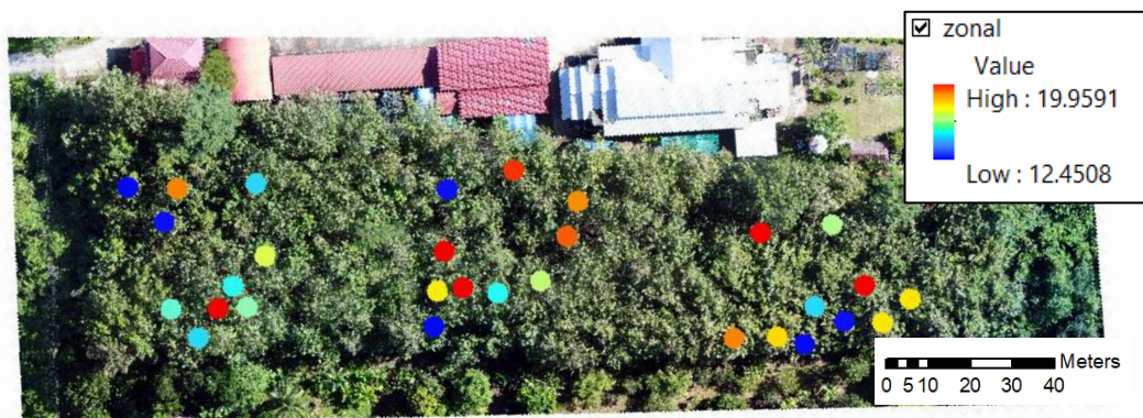
ภาพ 6 การคำนวณค่าความสูงด้วย Zonal statistics
