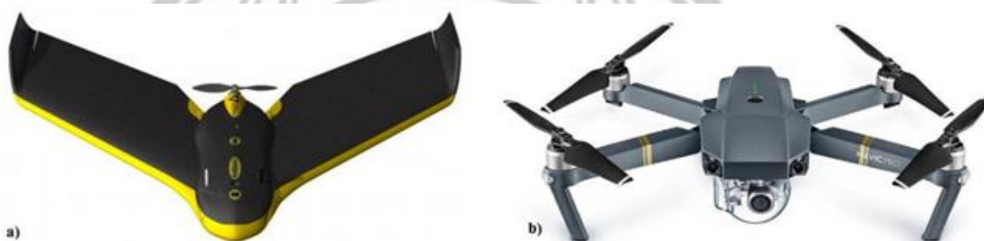
ภาพ 2.1 ประเภทอากาศยานไร้คนขับ (a)แบบ Fixed wing (b)แบบ Multirotors (Zietara et al, 2017)
