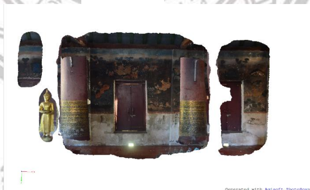
ภาพที่ 2.13 ตัวอย่างผลลัพธ์ที่ได้จาก close-range photogrammetry
