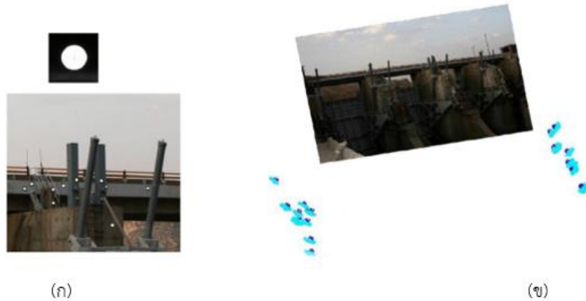
ภาพ 2.8 การติดตั้งและการถ่ายภาพเป้าหมาย (ก) เป้าหมายของการรั่วไหล, (ข) สำหรับการออกแบบเครือข่ายโฟโตแกรมเมทรี (Shirkhani et al., 2017)
