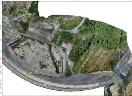
ภาพ 2.19 Planimetry ของจุดที่ได้รับ (จุดที่ได้รับและฐานการได้มาของเครื่องสแกนเลเซอร์) (Giuliaet et al., 2017)
