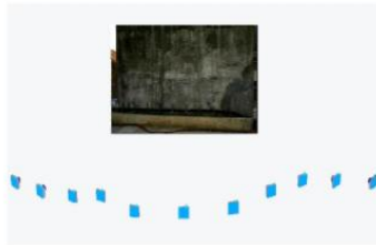
ภาพ 2.10 การกำหนดการถ่ายภาพที่เหมาะสม ด้านบน : มุมมองทดสอบ ด้านล่าง : การออกแบบโครงข่ายที่ใช้สำหรับการทดสอบด้านหน้า
