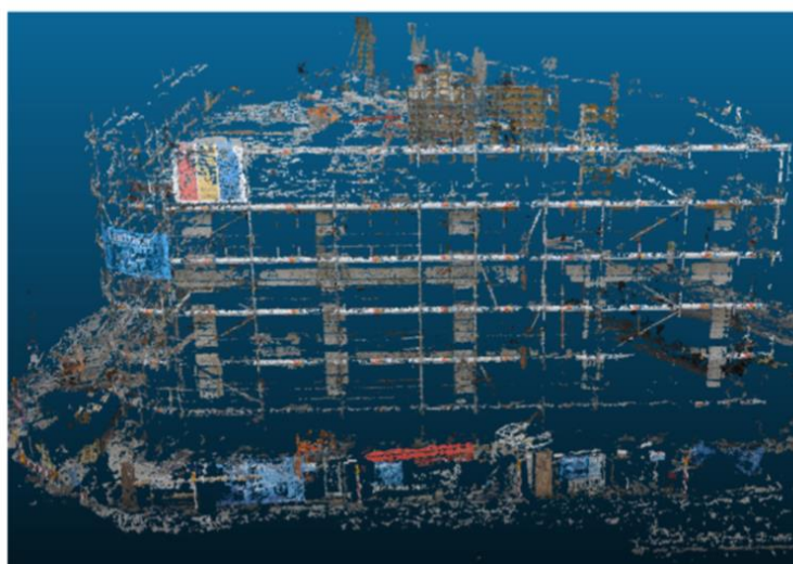
ภาพที่ 2.9 point cloud ที่สร้างจากภาพที่แสดงในภาพที่ 2.8 (Braun et al. , 2014)
