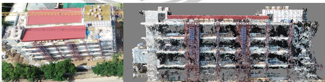
ภาพที่ 5.3 แสดงการเปรียบเทียบความต่างด้านหน้าของอาคารระหว่างภาพถ่ายกับแบบจำลองสามมิติ
