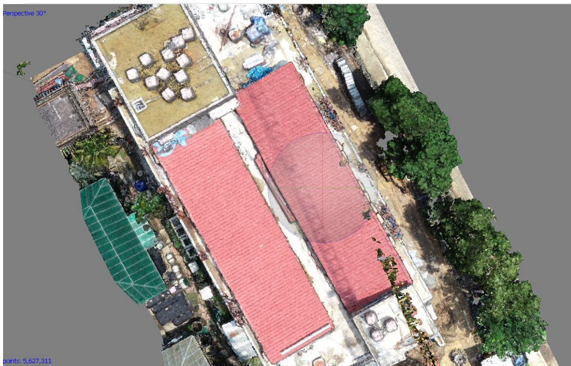
ภาพที่ 3.27 แสดงตัวอย่างการ Build Dense Cloud
