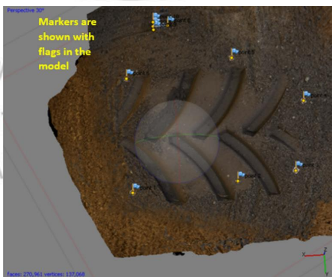
ภาพที่ 2.9 แบบจำลองสามมิติของพื้นผิวดินใน Agisoft PhotoScan (Kenarsari et al. 2017)
