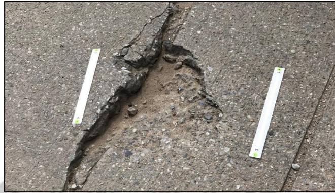
ภาพที่ 3.3 การวาง Scale Bar ก่อนทำการถ่ายภาพ
