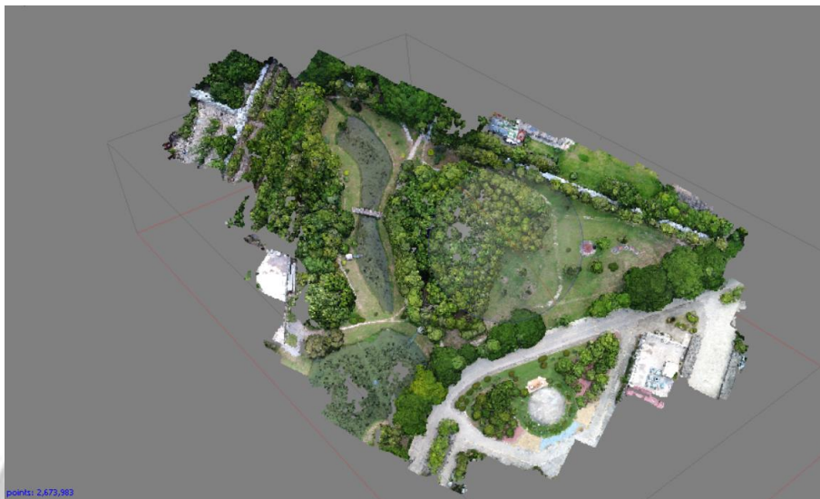
ภาพ 3.19 การประมวลผลข้อมูลภาพถ่ายทางอากาศจากอากาศยานไร้คนขับด้วยโปรแกรม Agisoft Photoscan
