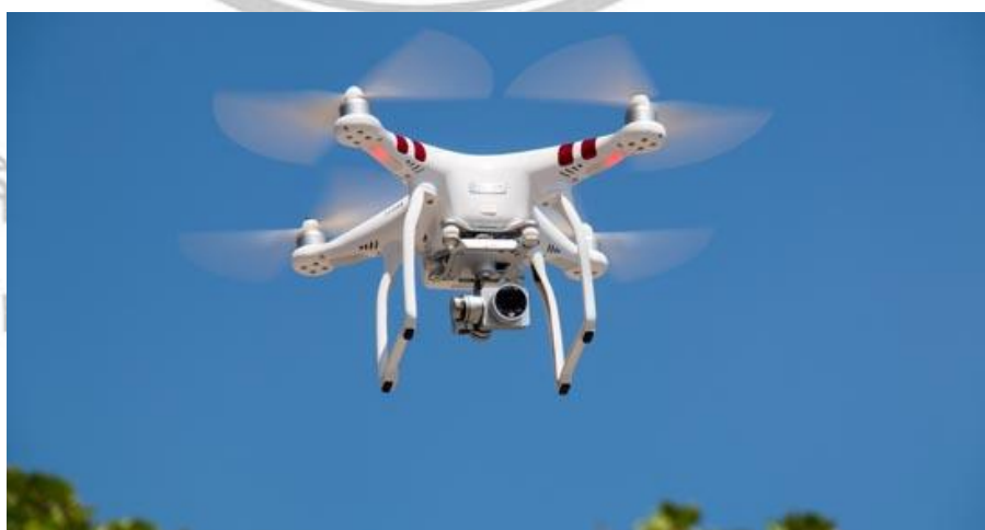
ภาพ 2.4 อากาศยานไร้คนขับชนิดปีกหมุน (Multirotor)
