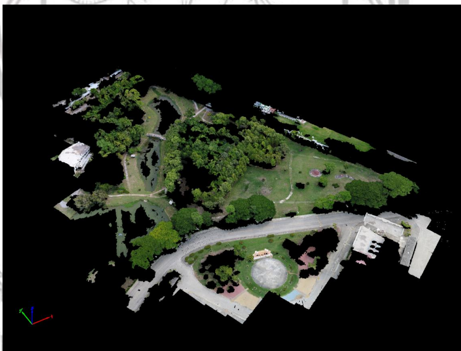
ภาพ 3.20 การประมวลผลข้อมูลภาพถ่ายทางอากาศจากอากาศยานไร้คนขับด้วยโปรแกรม Pix4Dmapper
