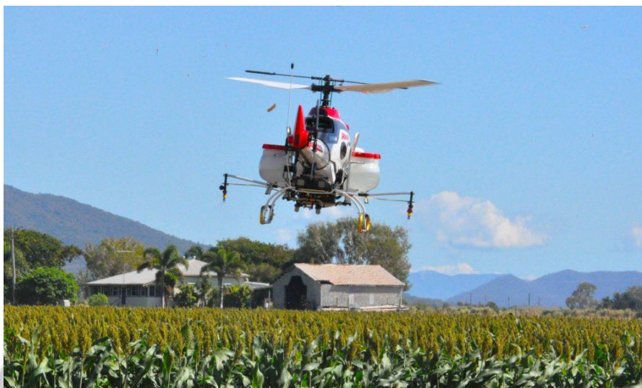
ภาพ 2.5 อากาศยานไร้คนขับชนิดปีกหมุนเดี่ยว (Single-Rotor Helicopter)
