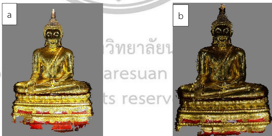
ภาพ 4 . 19 ผลลัพธ์ Point Cloud จากทดสอบ (a) การถ่ายแบบปกติ (b) การถ่ายแบบใช้ฟิลเตอร์โพลาไรซ์
