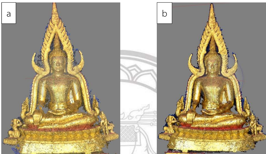
ภาพ 4. 10 ผลลัพธ์ Point Cloud จากทดสอบถ่ายภาพ (a) การถ่ายแบบปกติ (b) การถ่ายแบบใช้ฟิลเตอร์
