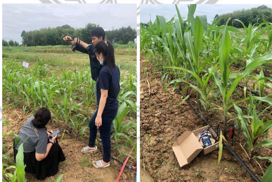
ภาพที่ 3.2. การลงพื้นที่ถ่ายภาพความร้อนพื้นผิวดินด้วยกล้องเทอร์โมสแกนและเซนเซอร์
