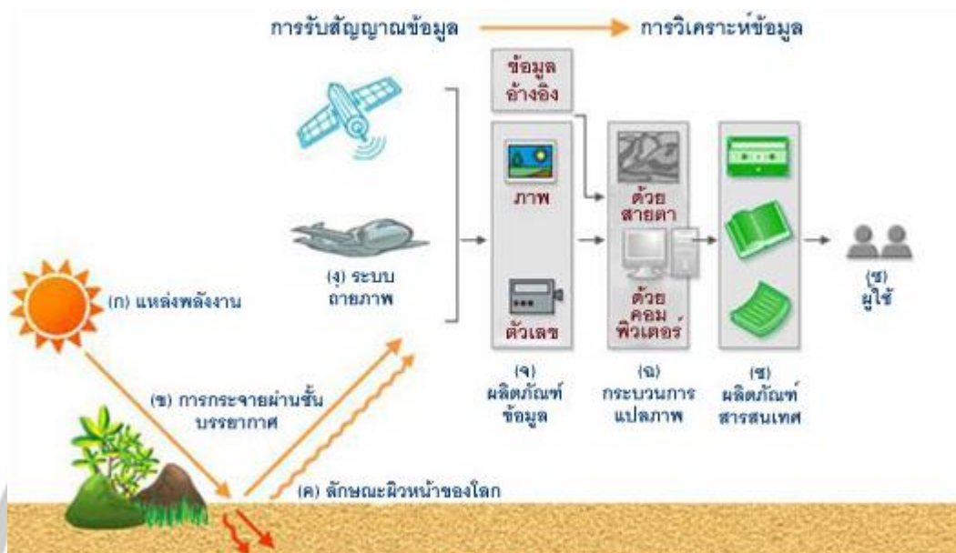
ภาพ 2.1 หลักการทำงาน Remote sensing
