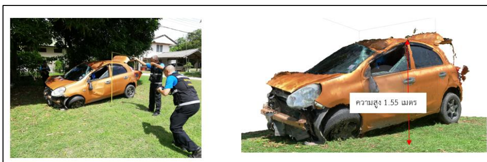
ภาพที่ 3.29 ตรวจเช็คร่องรอยความเสียหายของตัวรถบนซอฟต์แวร์ Agisoft Metashape โดยเปรียบกับรายงานการตรวจสอบร่องรอยความเสียหาย ของเจ้าหน้าที่ตำรวจพิสูจน์หลักฐาน
