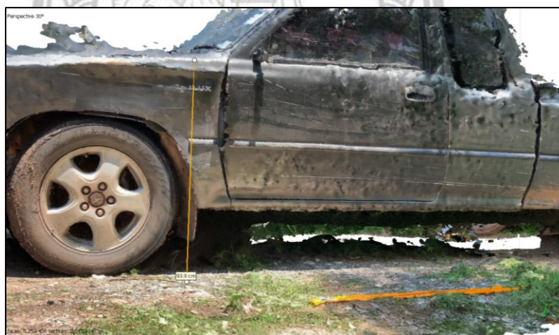
ภาพที่ 4.14 การตรวจสอบร่องรอยความเสียหายจากแบบจำลองสามมิติด้วยโปรแกรม Agisoft
