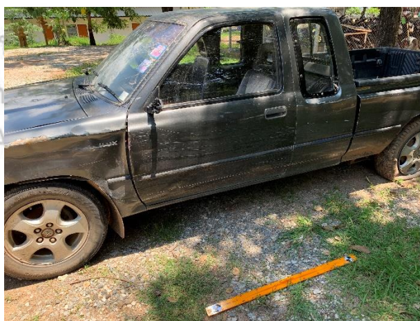
ภาพ 3.7 การวางไม้ scale bar พร้อมจุดควบคุมภาพ
