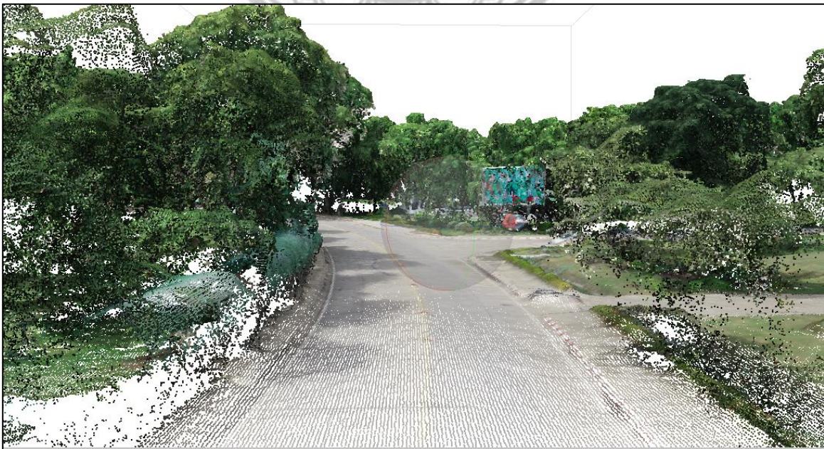
ภาพที่ 5.2 รายละเอียดทางดิ่งของแบบจำลองสามมิติไม่ครบถ้วน
