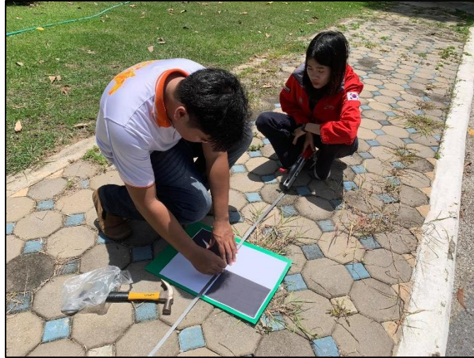
ภาพที่ 3.7 การวางจุดควบคุมภาพพร้อมวัดระยะระหว่างจุดควบคุมภาพ
