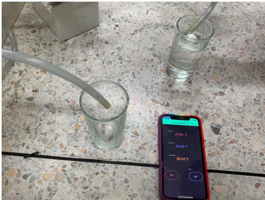
ภาพที่ 4.7 ผลการควบคุมการปิดปั้มน้ำบนมือถือ
