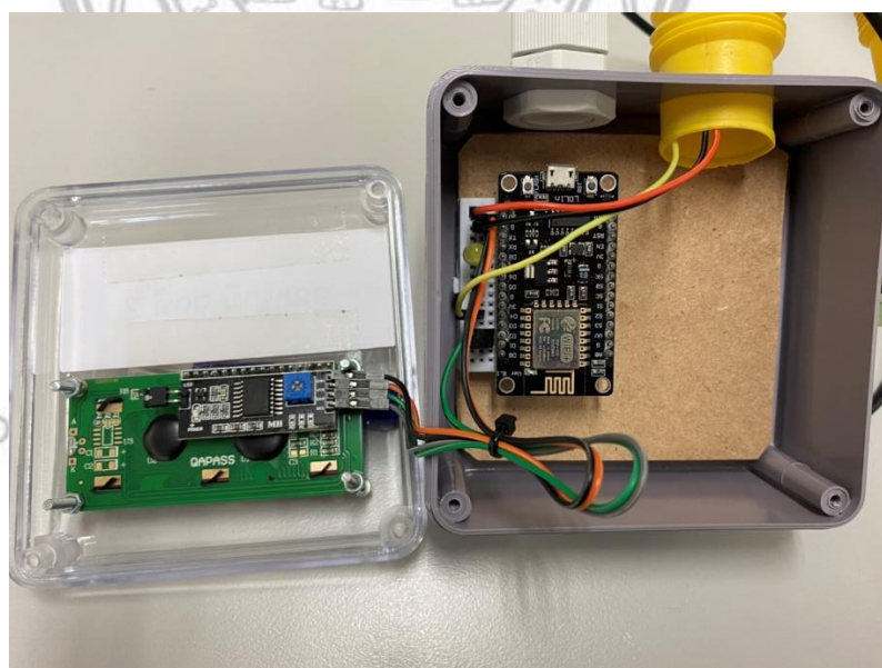
ภาพที่ 4.3 ภายในกล่องอุปกรณ์เซนเซอร์ที่ไม่มีโมดูล Relay
