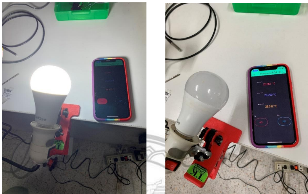
ภาพที่ 4.5 ผลการควบคุมการเปิด - ปิด ไฟ LED
