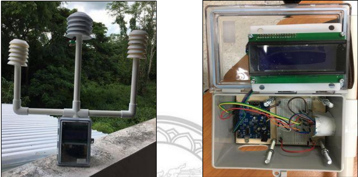
ภาพที่ 4.1 ผลการออกแบบและพัฒนาอุปกรณ์เซนเซอร์
