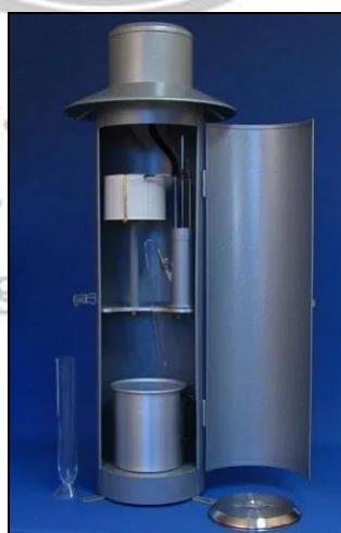
ภาพ 2.4 เครื่องวัดน้ำฝนแบบทุ่นลอยหรือแบบไซฟอน (Theconstructor, 2017)
