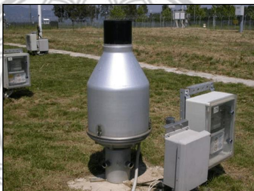
ภาพ 2.3 เครื่องวัดน้ำฝนแบบชั่งน้ำหนัก (Matteo Colli, 2014)
