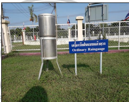
ภาพ 2.1 เครื่องวัดน้ำฝนแบบธรรมดาหรือแบบแก้ววุง
