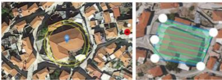
ภาพ 2. 10 แผนการบินถ่ายภาพแบบ CIRCULAR (A) และ GRID (B) (S. Chatzistamatis et al, 2018).
