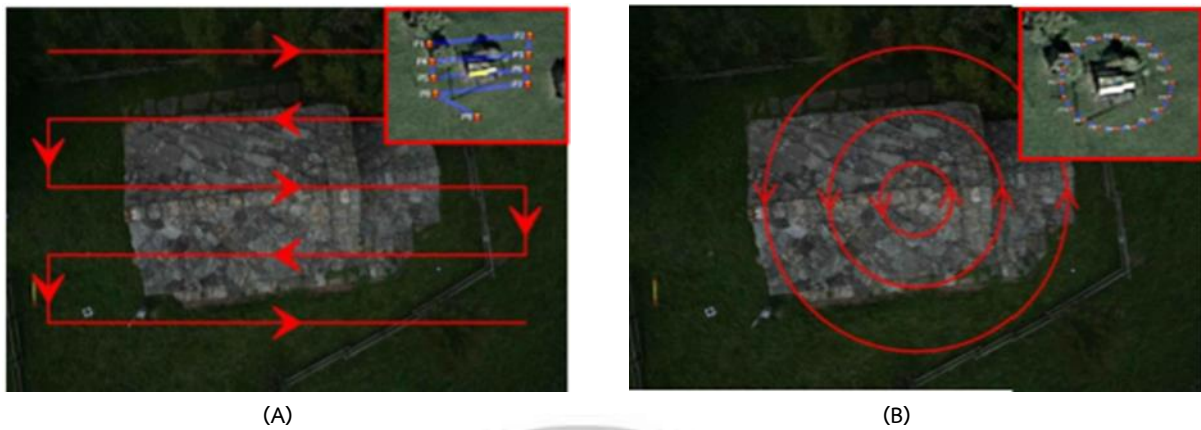
ภาพ 2. 4 รูปแบบแผนการบินแบบ GRID (A) และ CIRCULAR (B)(I. Aicardi et al, 2016).
