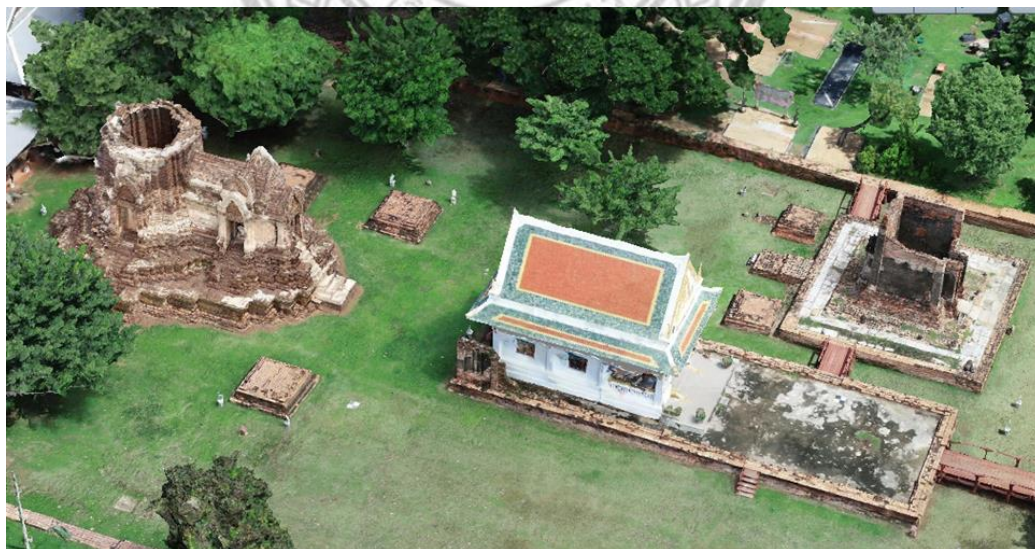
ภาพ 4. 7 แบบจำลองสามมิติโบราณสถานการประมวลผลการบินถ่ายภาพแบบ UAV และ Close-range photos
