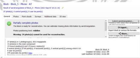
ภาพที่ 3. 17 การประมวลผลภาพถ่ายภาคพื้นดินที่ใช้จุด GCP และ Tie points
