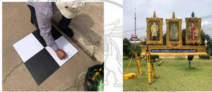
ภาพที่ 3. 12ภาพที่ 3.13 การวางจุดควบคุมภาพถ่าย (GCP) และ การเก็บตำแหน่งด้วย GNSS
