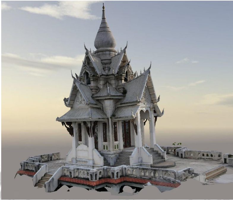
ภาพที่ 4. 8 แบบจำลองสามมิติบริเวณหอพระเทพรัตน์ ประมวลผลด้วยการบินถ่ายภาพ UAV
