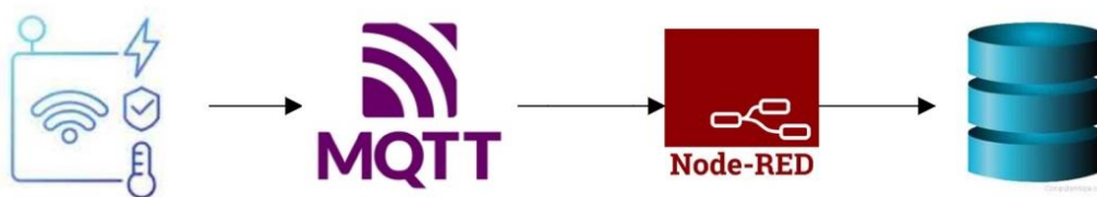
ภาพที่ 3.12 แสดงลำดับการรับส่งข้อมูลจากเซนเซอร์ไปยัง MQTT, Node-RED และบันทึกเข้าฐานข้อมูล
