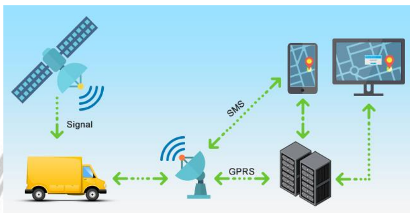
ภาพที่ 1.2 หลักการทำงานของ GPS Tracking
