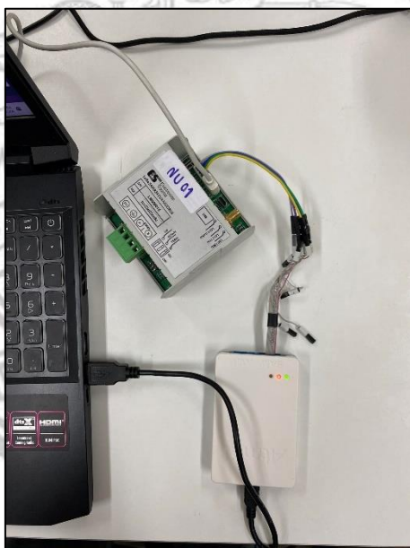
ภาพที่ 3.25 การตรวจสอบการใช้งานของ LoRaSAMR34
