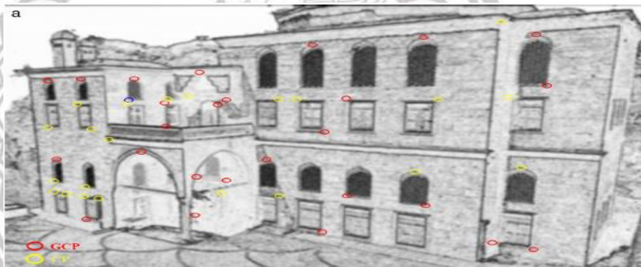
ภาพที่ 2.9 ภาพแบบจำลองด้วยอากาศยานไร้คนขับขนาดน้ำหนักเบา
