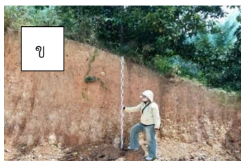
ภาพที่ 2 การสำรวจเก็บข้อมูลร่องรอยแผ่นดินถล่ม และบันทึกลักษณะของร่องรอย
